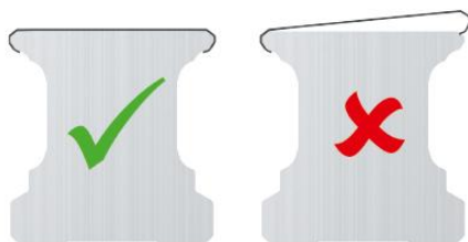
5.45. ábra: Helyesen és helytelenül felszerelt borítószalag
